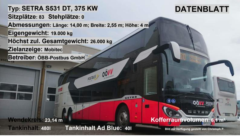
Motor: Reihen 6-Zylinder Dieselmotor MB OM 471 Euro VI Getriebe: Mercedes-Benz GO 250-8 PowerShift, 8-Gang
